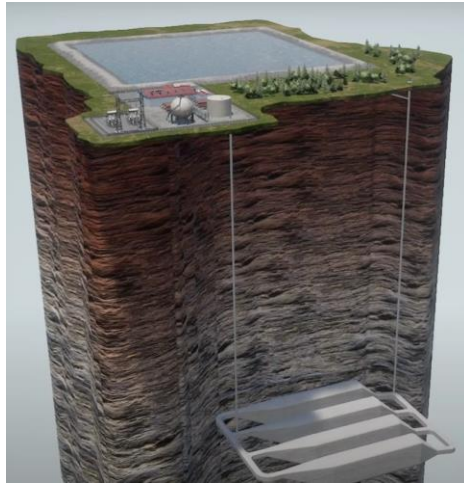
Figura 27: Ejemplo de CAES desde Hydrostor. Fuente: https://www.hydrostor.ca/
